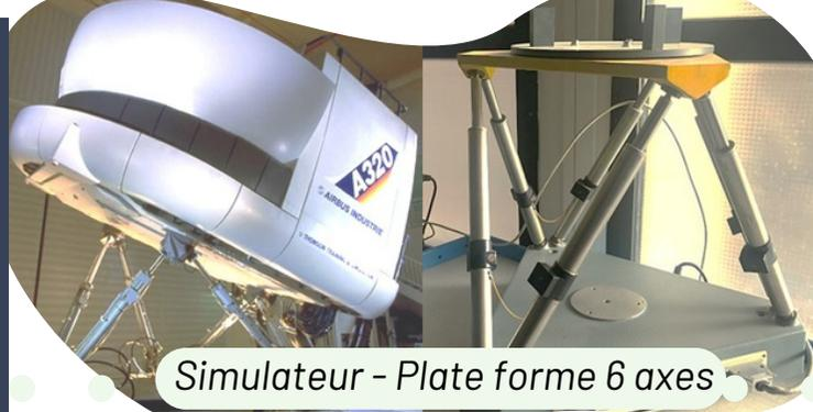
Simulateur - Plate forme 6 axes
